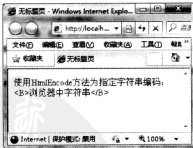
图 9.20 输出编码后的字符串
