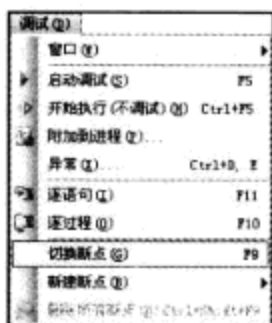
图 17.6 右键插入断点 图 17.7 菜单栏插入断点
