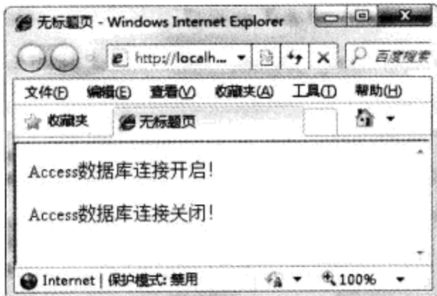
图 10.5 用 OleDbConnection 对象的 State 属性判断连接状态
