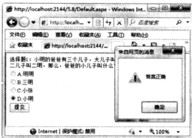
图 11.22 使用 RadioButton 控件模拟考试系统
