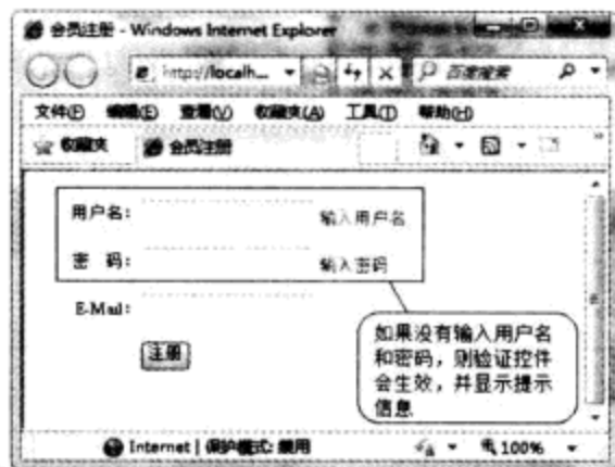
图 14.4 RequiredFieldValidator 检查必要的输入
