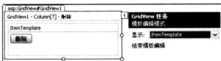
图 12.3 模板列中添加一个 ImageButton 控件用于执行删除操作
