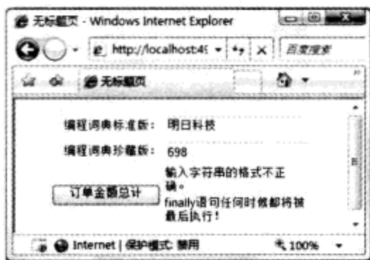
图 17.26 即使发生异常,仍然执行 finally 语句块中的程序代码
