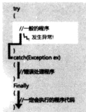
图 17.24 程序中发生异常并用 catch 捕获，最后执行 finally 语句块中的程序代码
