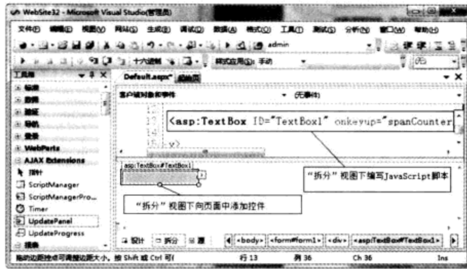
图 3.2 在“拆分”视图中添加控件
