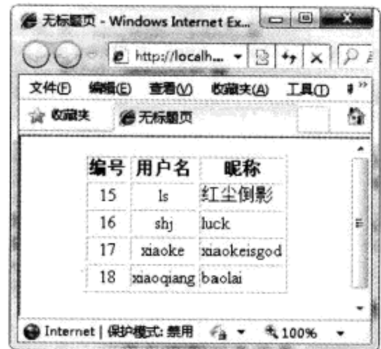
图 10.21 用 SqlDataReader 对象读出 SELECT 语句的查询结果
