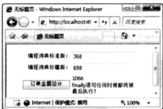
图 17.25 程序顺利执行并显示 finally 语句块中的信息
